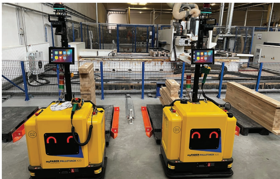
Roboty myFABER Palletjack X20 převázejí ve výrobě firmy Intermont velkoformátové desky mezi výrobními operacemi. / Foto: KVADOS Group
