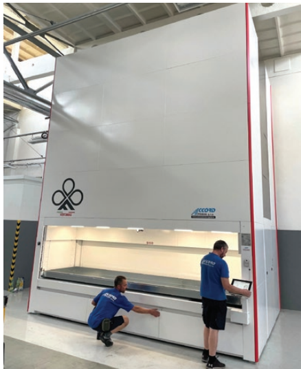
Hlavní výhoda zakladačů: automatizované skladování na velmi malé ploše, do výšky. / Foto: ACCORD PRAHA
