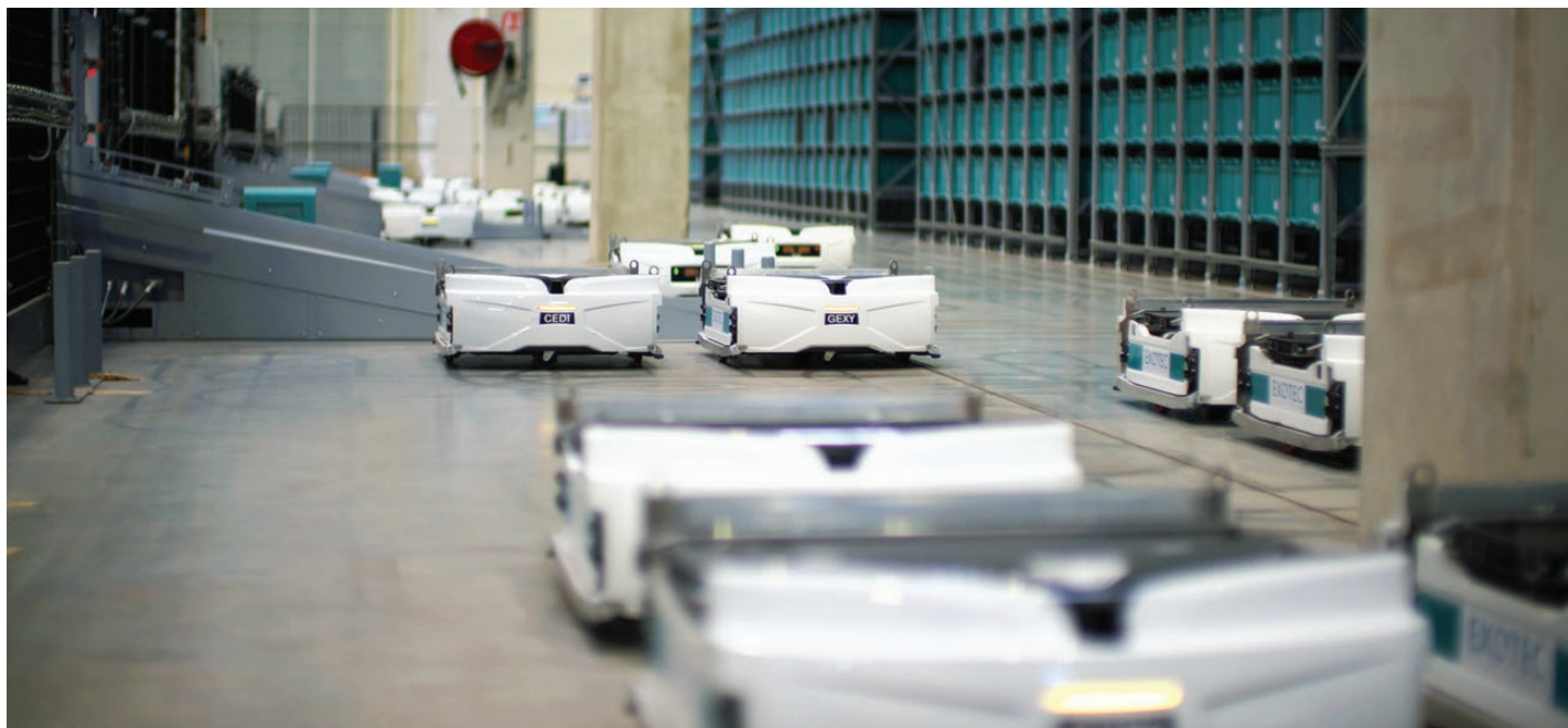
V automatizovaném skladu se o plynulý přesun zboží mohou starat autonomní mobilní roboty. / Foto: Prologis
