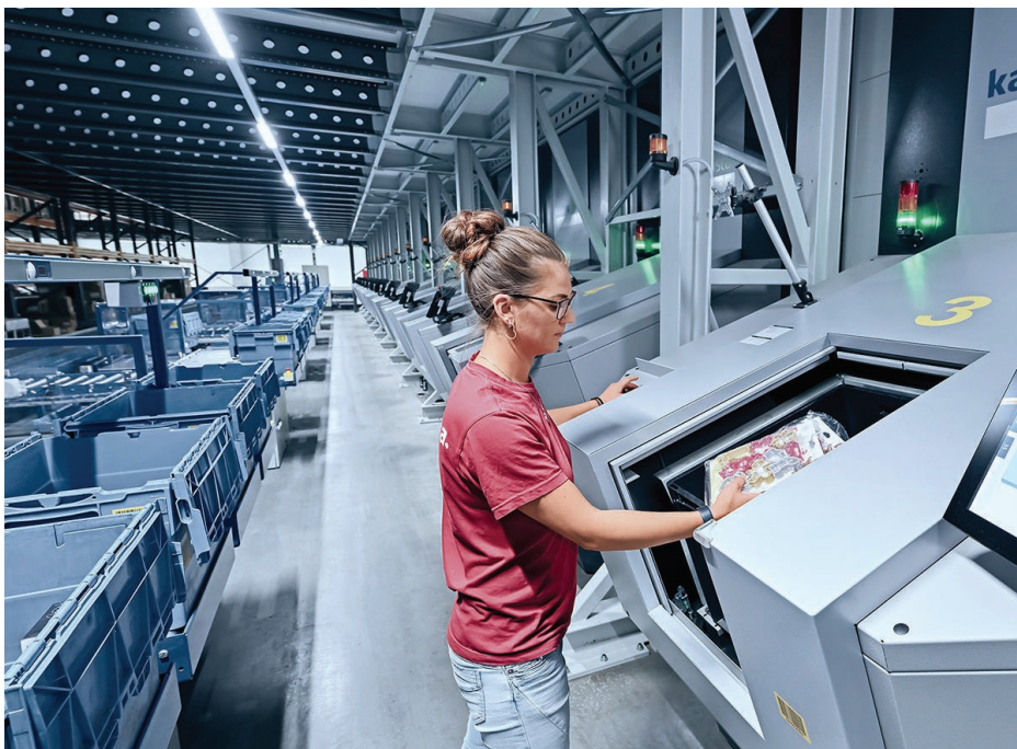
Snímek ze skladu společnosti Tescoma. Díky automatizaci nemusí operátor hledat zboží v regálovém skladu, zboží přijede do výdejního okna. / Foto: Kardex
