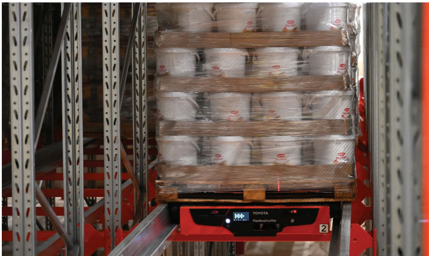
Ve vysokohustotním automatizovaném skladu zajišťují přepravu palet mobilní podvozky Radioshuttle. / Foto: Toyota Material Handling CZ
