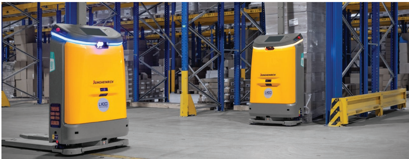
Autonomní mobilní roboty Jungheinrich EAE 212a zajišťují ve skladu DURABLE přepravu palet od příjmu zboží k dalšímu zaskladnění. / Foto: Jungheinrich
