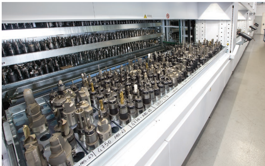
V automatizovaných skladových věžích lze skladovat například polotovary, součástky, nástroje i náhradní díly. / Foto: SysTech Group
